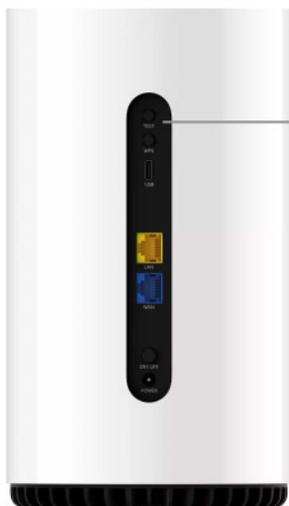
Nota: presione el botón TEST en el costado del equipo para verificar la intensidad de la señal en cualquier momento.
