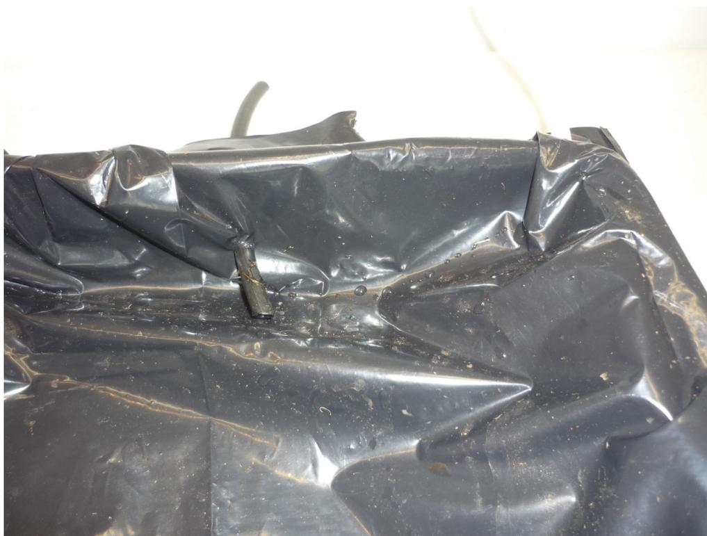
Figura 9 Drenaje colocado en la bandeja a 3 cm del fondo.
