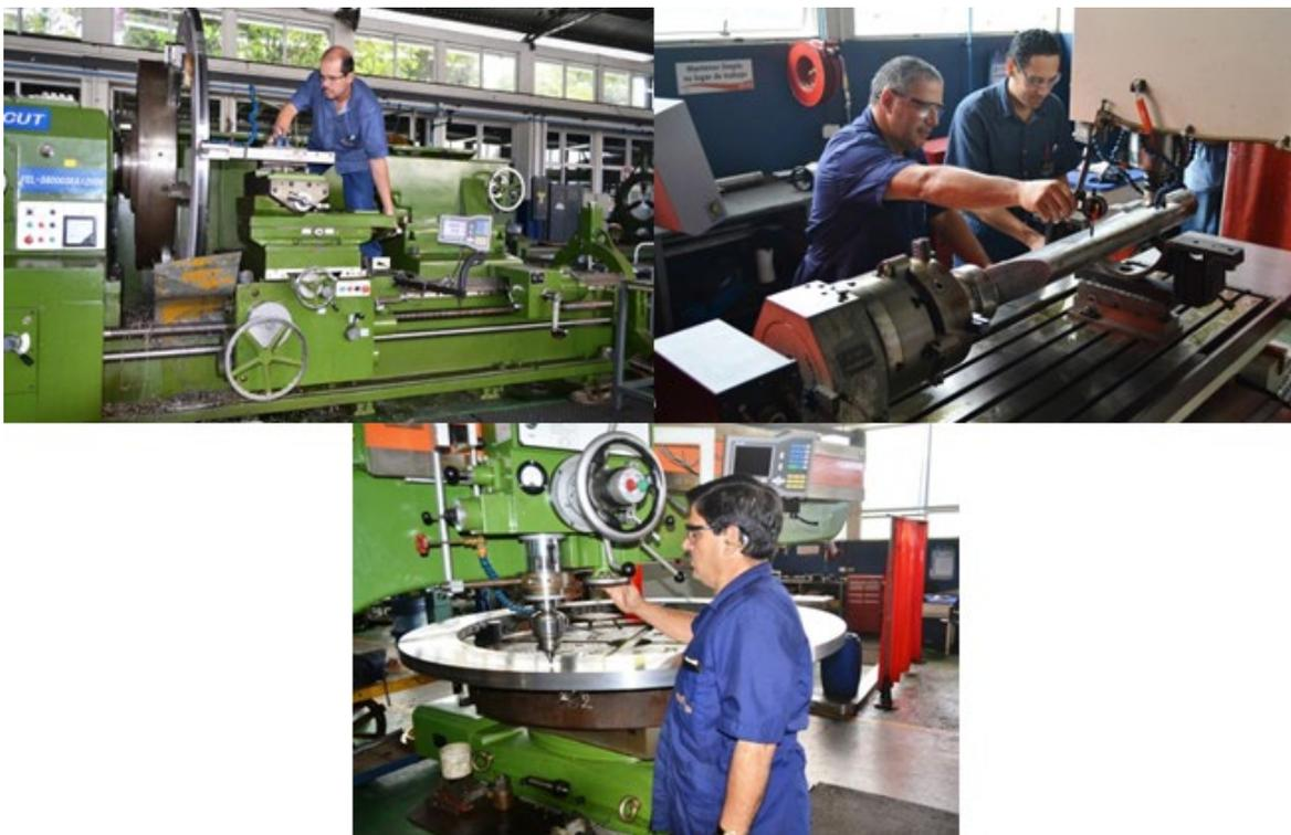
Este proceso se especializa en la labores de mecanizado de los diferentes elementos de las turbinas hidroeléctricas y de la industria pesada en general, mediante la utilización de tornos, taladros y fresadoras convencionales, así como la utilización de tecnología de mecanizado de control numérico (CNC).
